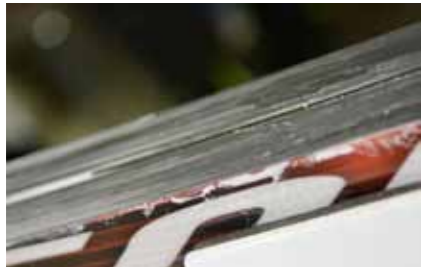
Zu schnell trocken: Mit falschem Lösemittel bildet sich kein homogener Film, Wachs und Additive verteilen sich ungleichmäßig.
