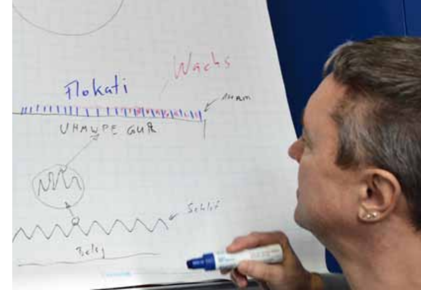
Zipp'sches Triumvirat (unten v. l.): Entwicklungsleiter und „Chemie-Brain“ Dr. Jürgen Herber, Frank Zipp und Dipl.-Ing. Wolfgang Storbek beim Blick auf einen stark vergrößerten Skibelag. Oben: die drei Stufen der „Unebenheiten“ von der Belagstruktur (u.) über Materialrauigkeiten (Kreis) bis zum molekularen „Flokati“ auf My-Meter-Niveau.
